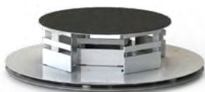
НПП/П-45 — поворотная двухуровневая платформа с верхней подставкой и диаметром основания 450 мм, позволяет разместить 4 лотка типа Cosis A и 4 лотка типа Cosis B. Высота 100 мм
